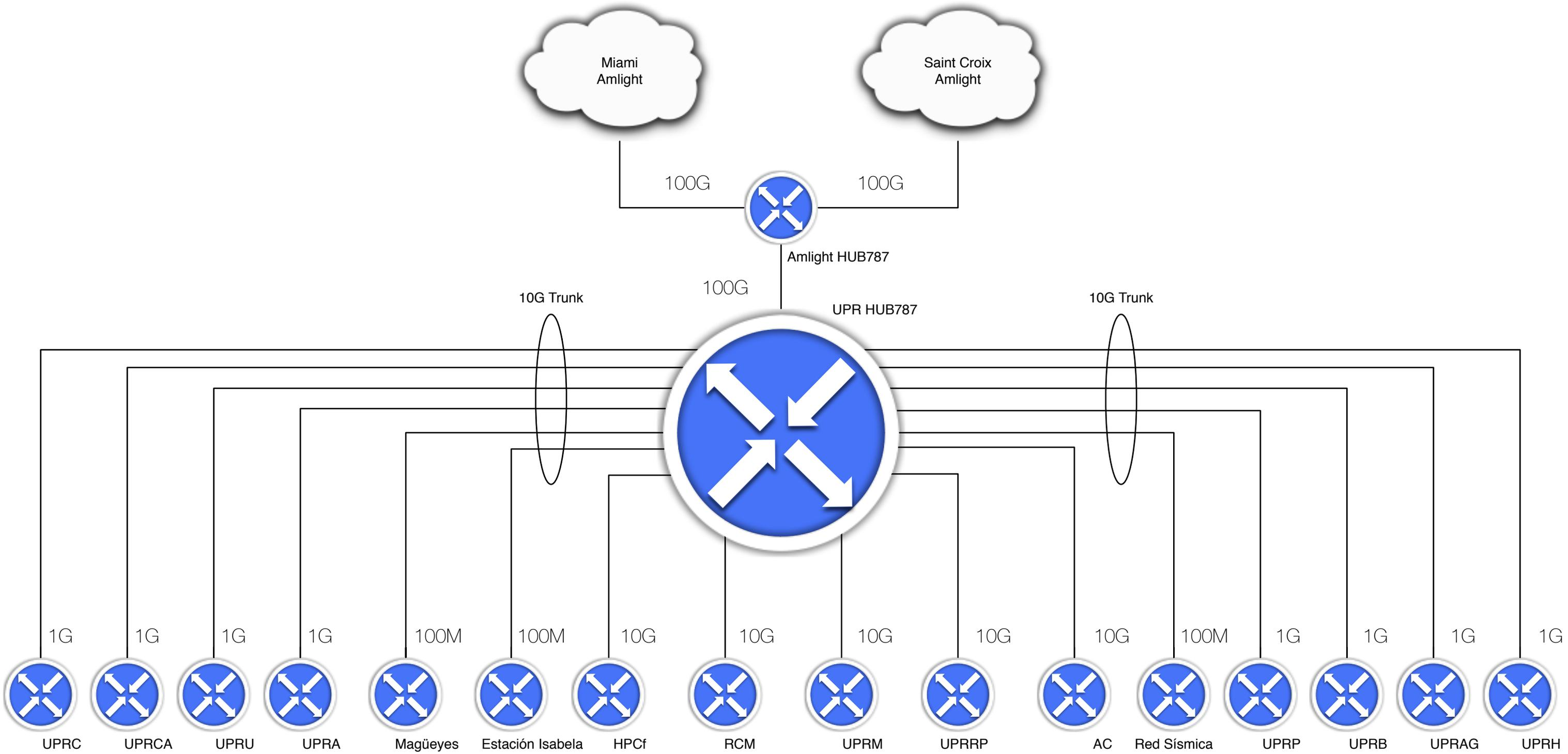
Configuración final en donde todos los conectores terminan lógicamente en “router” de la UPR en HUB787 por medio de los enlaces provistos por Claro. El tráfico al “commodity” e Internet 2 es enrutado por medio del acuerdo con AmLight. Los conectores con capacidad de 1 Gbps o menos son agregados en un “trunk”.
